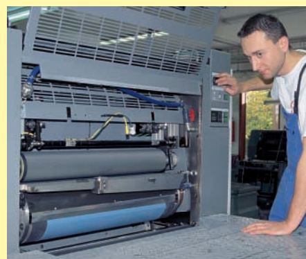
Drucker Marco Seebeck am geöffneten Lackturm der Ryobi 755 mit Anilox-Walze und optionaler Kammerrakel.
